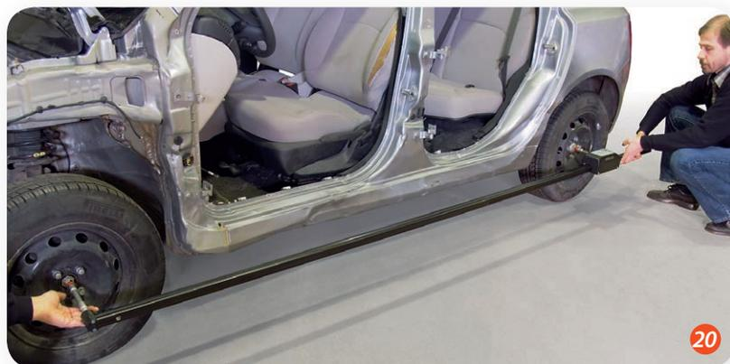
La pigne de mesure EzCalibre peut exécuter plusieurs fonctions spéciales : mesure symétrique, mesure diagonale/croisée, mesure de la distance et de la largeur etc. Ce qui aide le carrossier à accomplir une large variété de travail en un minimum de temps.
