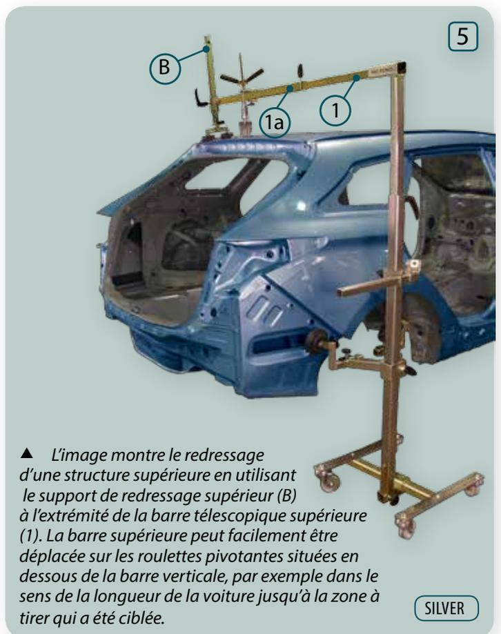
▲ L'image montre le redressement d'une structure supérieure en utilisant le support de redressement supérieur (B) à l'extrémité de la barre télescopique supérieure (1). La barre supérieure peut facilement être déplacée sur les roulettes pivotantes situées en dessous de la barre verticale, par exemple dans le sens de la longueur de la voiture jusqu'à la zone à tirer qui a été ciblée.
