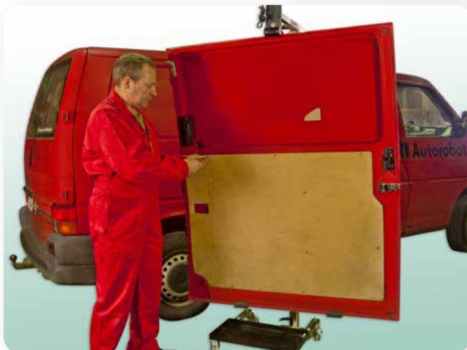
◀ L'image montre à quel point la porte peut être facilement déplacée vers l'endroit souhaité pour être manipulée après avoir été retirée. Le SmartPuller équipé de roulettes rend le déplacement très facile.
