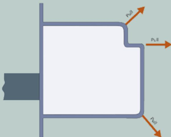
La technologie SmartPuller permet de débosser les bas de caisses dans toutes les directions souhaitées. La structure des tampons réglables en caoutchouc leur permet de prendre une forme qui ne va pas endommager la partie porteuse. Pour un déboselage plus contraignant il est possible d'utiliser deux vis de tirage. Pour les endroits ciblés où il y a très peu d'espace de tirage, il est possible d'utiliser une vis de tirage courte (A) (voir images 2 et 4).
