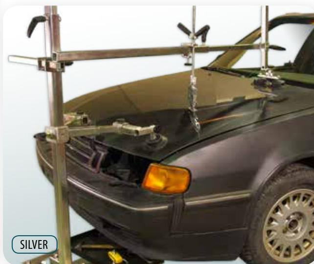
▼ Le support de redressage est facilement réglable sur la barre verticale (2) aussi facile que le réglage des tampons en caoutchouc vers le bas, ce qui permet de redresser vers la bonne direction. Choisir un angle de traction continue accélère le redressage.
