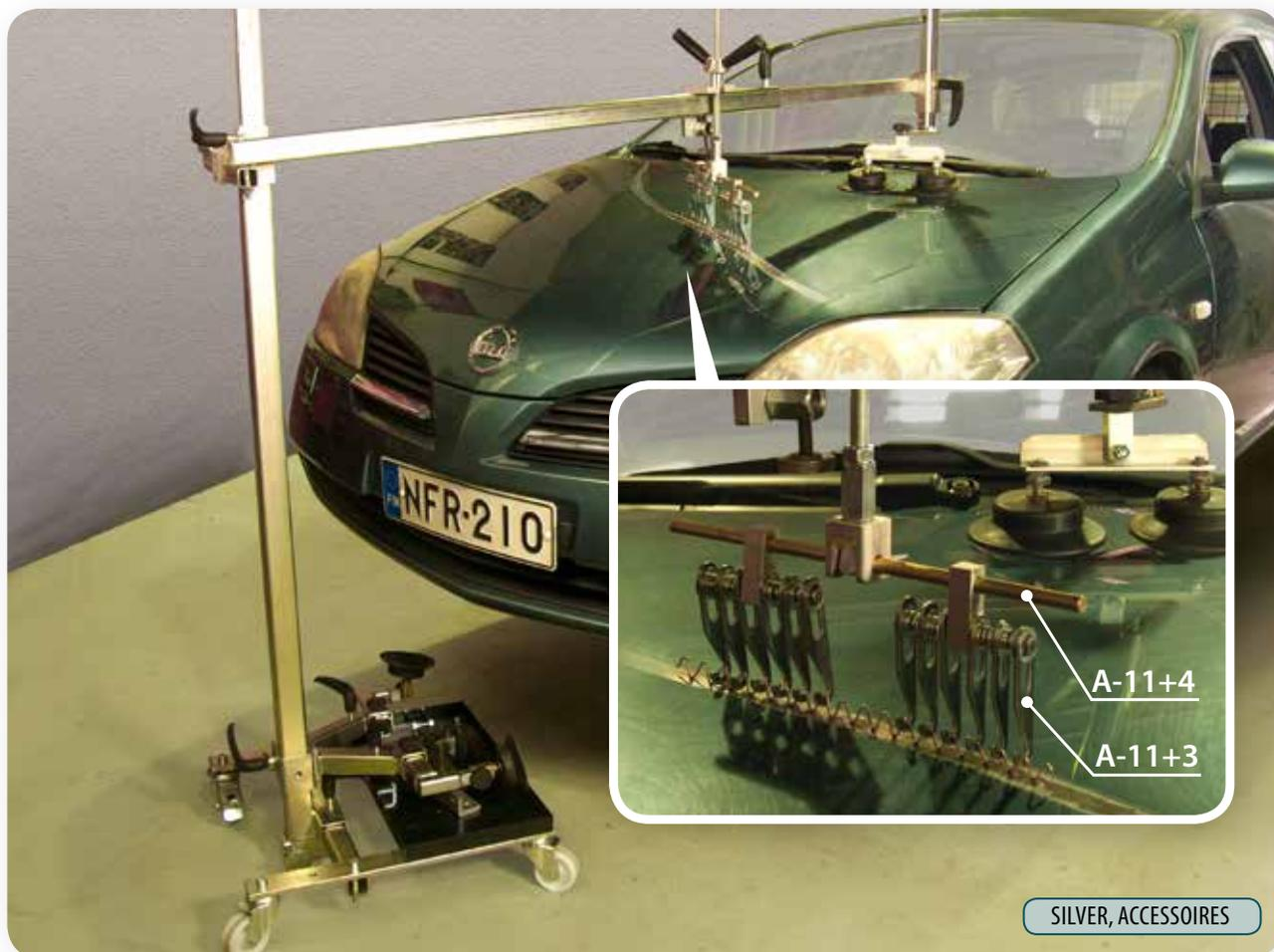
▲ Lorsque le coffret Argent SmartPuller est équipé de la pince à multi-tête à A-11+3, le débosselage peut être réalisé simultanément sur une grande partie. Cela rend plus rapide le débosselage de longues bosses par exemple (voir l'image).
