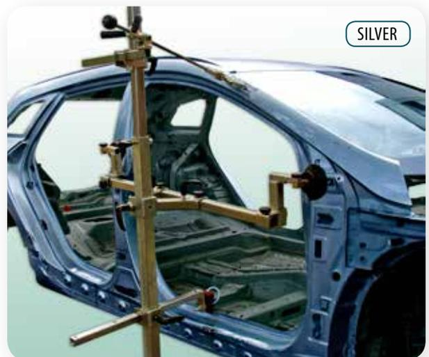
Le redressement rapide avec le SmartPuller est basé sur la barre verticale (1) équipée avec des roulettes et sur lequel les tampons (2) sont réglables en largeur et dans le sens de la hauteur du véhicule sur les structures solides de la carrosserie au bord de la zone de débosselage. Après cela le débosselage peut être réalisé avec la vis de tirage (3) qui couvre la zone (A). Le débosselage de la zone en question réussi sans déplacer le SmartPuller.
