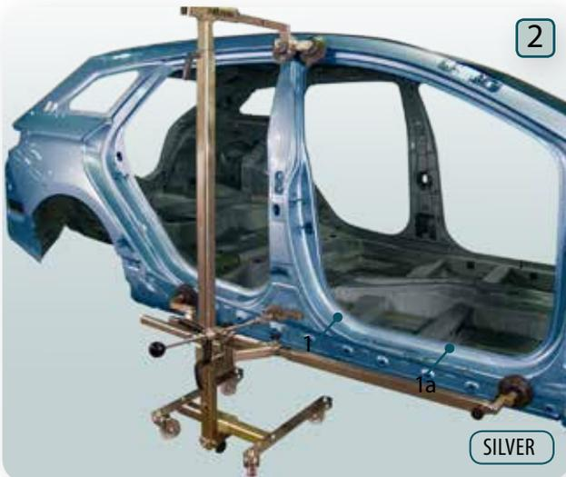
▲ L'image montre le redressement d'un bas de caisse où les tampons en caoutchouc inférieurs ont été fixés aux extrémités du bas de caisse en utilisant une barre supplémentaire (1) dans le but de pouvoir redresser le panneau entier. La barre supplémentaire (1) est fournie dans le coffret SmartPuller Argent.
