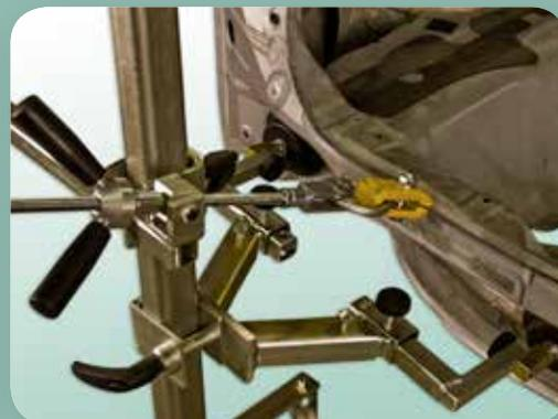
En utilisant une tour télescopique (1), vous pouvez avoir un support plus haut et un appui supérieur (2) sur une partie solide. Cela permet de choisir le meilleur axe de redressement possible dans le sens de la hauteur de la largeur. Le débosselage se fera avec une ou deux vis de tirage.
