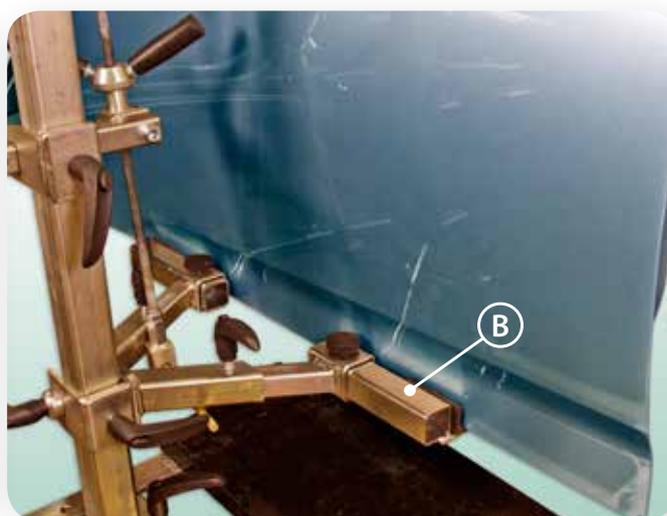
▲ *Le support inférieur (B) de la porte est équipé avec un capitonnage, grâce auquel le dispositif fonctionne aussi bien avec des portes peintes.*
