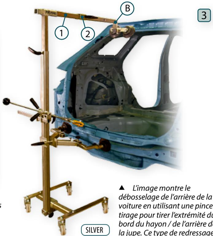
▲ L'image montre le débosselage de l'arrière de la voiture en utilisant une pince de tirage pour tirer l'extrémité du bord du hayon / de l'arrière de la jupe. Ce type de redressement requiert l'utilisation d'une barre supplémentaire (1), qui est placée à l'extrémité arrière du toit comme indiqué sur l'image.
