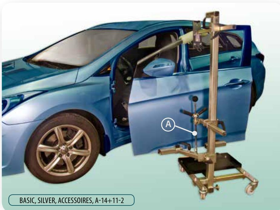
▲ *Un kit supplémentaire du SmartPuller rend la manipulation des portes très simple, par exemple pour remplacer des portes. Placer la porte devient facile lorsque vous pouvez régler la hauteur de la porte avec la vis (A).*
