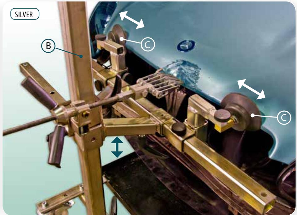
▲ Les tampons réglables en caoutchouc (C) situés sur la barre verticale (B) du SmartPuller procure un support de redressement rapide. Cela permet de réaliser des travaux de débosselage variés sans avoir besoin de monter le véhicule sur un système de redressement.
