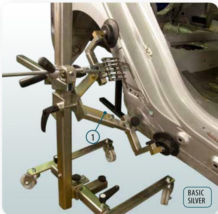
◀ Le support de redressage (1) du SmartPuller est placé sur une partie solide de la carrosserie pour obtenir le meilleur résultat de débosselage possible. Le sens de débosselage peut être librement choisi.
