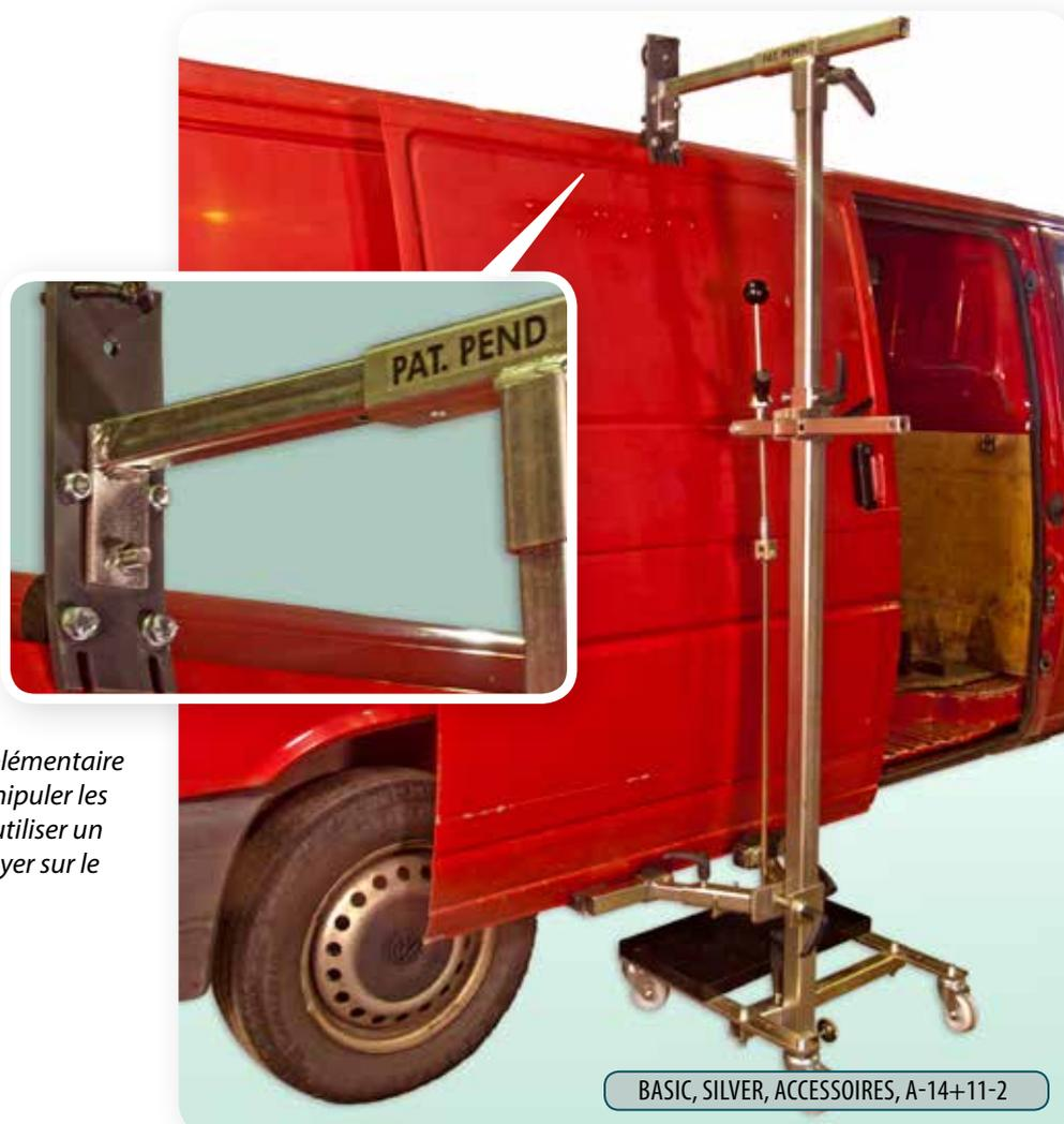
► L'image montre comment le kit supplémentaire du SmartPuller fonctionne pour manipuler les portes lourdes, dans quel cas il faut utiliser un support multifonctionnel pour appuyer sur le cadre supérieur de la porte.
