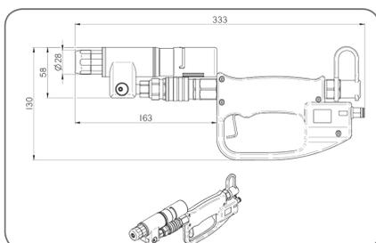
**Outil de pose de rivets aveugles avec unité de commande**
