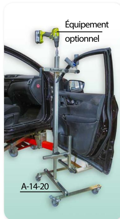
Le chariot multifonction avec la barre d'extension A-14-21 (pièce supplémentaire) sert à retirer, installer et assembler des portes de véhicules utilitaires. Le réglage de la hauteur se fait à l'aide d'une manivelle manuelle ou d'une perceuse/visseuse sans fil.
