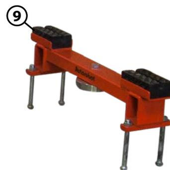
Composition basique : 2+1 pinces d'ancrage et 1 équerre de traction pour les carrosseries qui réparent les petits et moyens chocs des véhicules avec renfort de bas de caisse.
